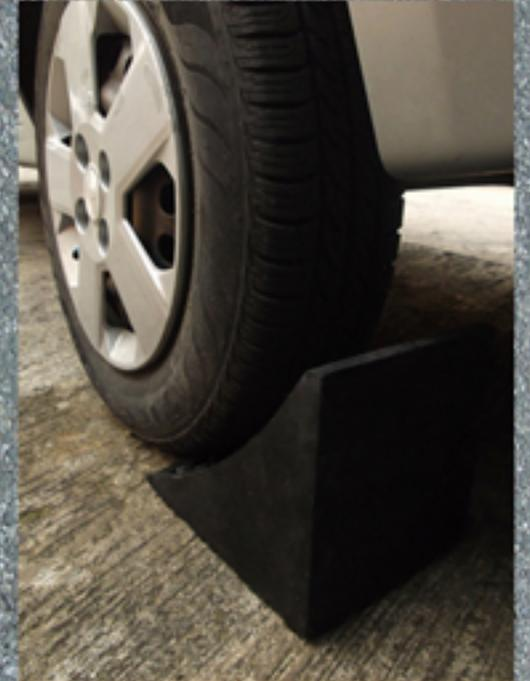
Estas cuñas se colocan en las ruedas de un remolque o camión impidiendo su movimiento estando estacionados. Su antiderrapante en la parte superior e inferior evita deslizamientos.
